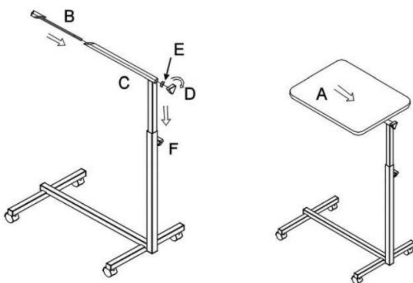
Deslice el tablero A en el tubo de deslizamiento C y apriete el pomo de sujeción D.
