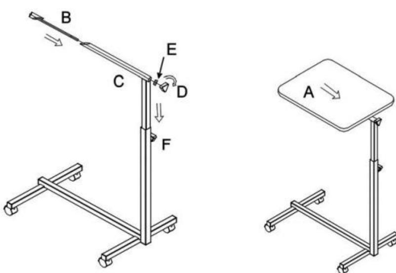
Glisser le plateau A dans le tube coulissant C et serrer le bouton de serrage D.
